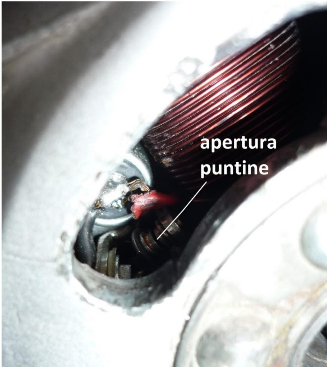
Trovato il punto di massima apertura teniamo fermo il volano e mettiamo fra le puntine lo spessore adatto e vediamo quanto sono aperte. (Apertura deve essere compresa fra 0,3 e 0,5 mm)
