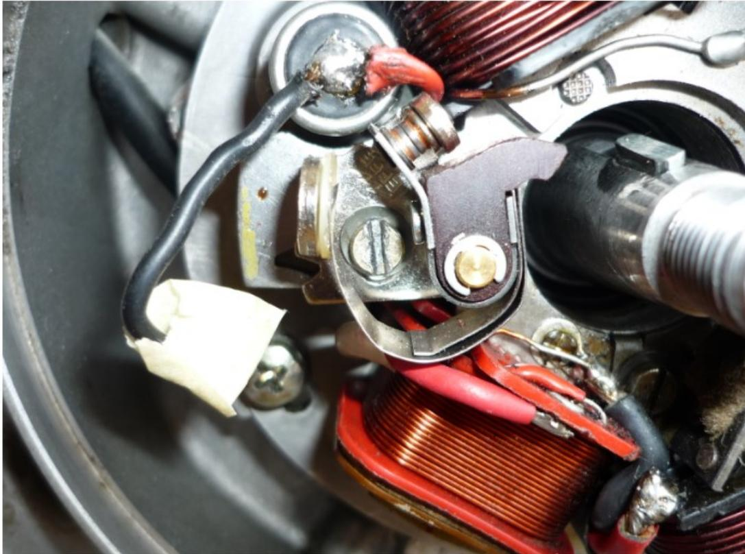
Infiliamo un cavo piccolo nel condotto del carter sotto la cassetta di derivazione fino ad arrivare allo statore
