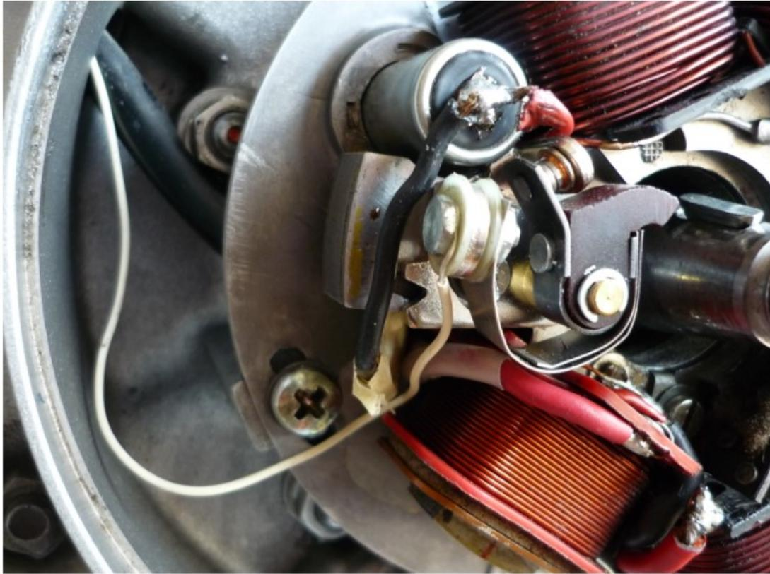
Collegare il capo del cavo che esce dal carter ad un tester (o a qualunque cosa che rilevi un passaggio di corrente come una lampadina o led con una batteria): il cavo lo colleghiamo ad un puntale del tester e l'altro puntale lo mettiamo a massa del motore. Poi mettere il tester in modalità di continuità con segnale acustico, così da emettere un suono finchè le puntine sono chiuse (ossia quando passa corrente)
