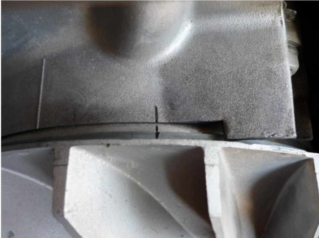
Ruotare sia il volano sia il disco (solidale al volano) in senso antiorario fino a battuta contro il bloccapistone
